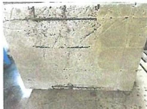
Anmerkung: An der Unterseite der Estrichplatte befand sich eine Eisenmatte (siehe Foto). Bei der Prüfkörperentnahme wurde darauf keine Rücksicht genommen.
